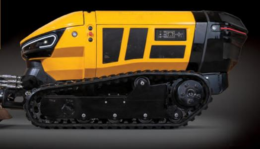
55 DEGREE SLOPE CAPACITY
